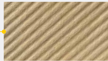
Zellulose ist als Basismaterial bei der Ölfiltration beständig und verfügt über eine hohe Festigkeit.
