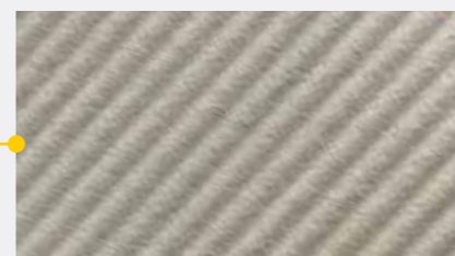
Das Non-Curing (NC)-Medium kommt bei der Luftfiltration zum Einsatz.
